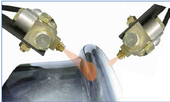
Figuur 10: Voertuiggebonden flenssmering
